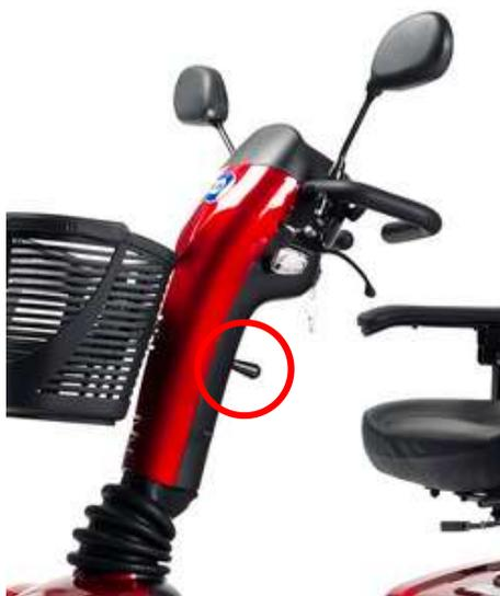
Die Lenkeinheit kann in viele verschiedene Positionen (stufenlos) passend für jeden Fahrer eingestellt werden.
