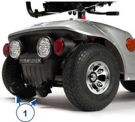
Am Rahmen des Scooters ist auf der Rückseite ein Kippschutz (1) befestigt. Dieser Kippschutz kann nicht entfernt werden. Er ist für Ihre Sicherheit da. Er verhindert, dass der Scooter nach hinten umkippt, wenn Sie über kleine Hindernisse fahren, die NICHT die maximale Höhe überschreiten, die in Abschnitt 5 angegeben ist.
